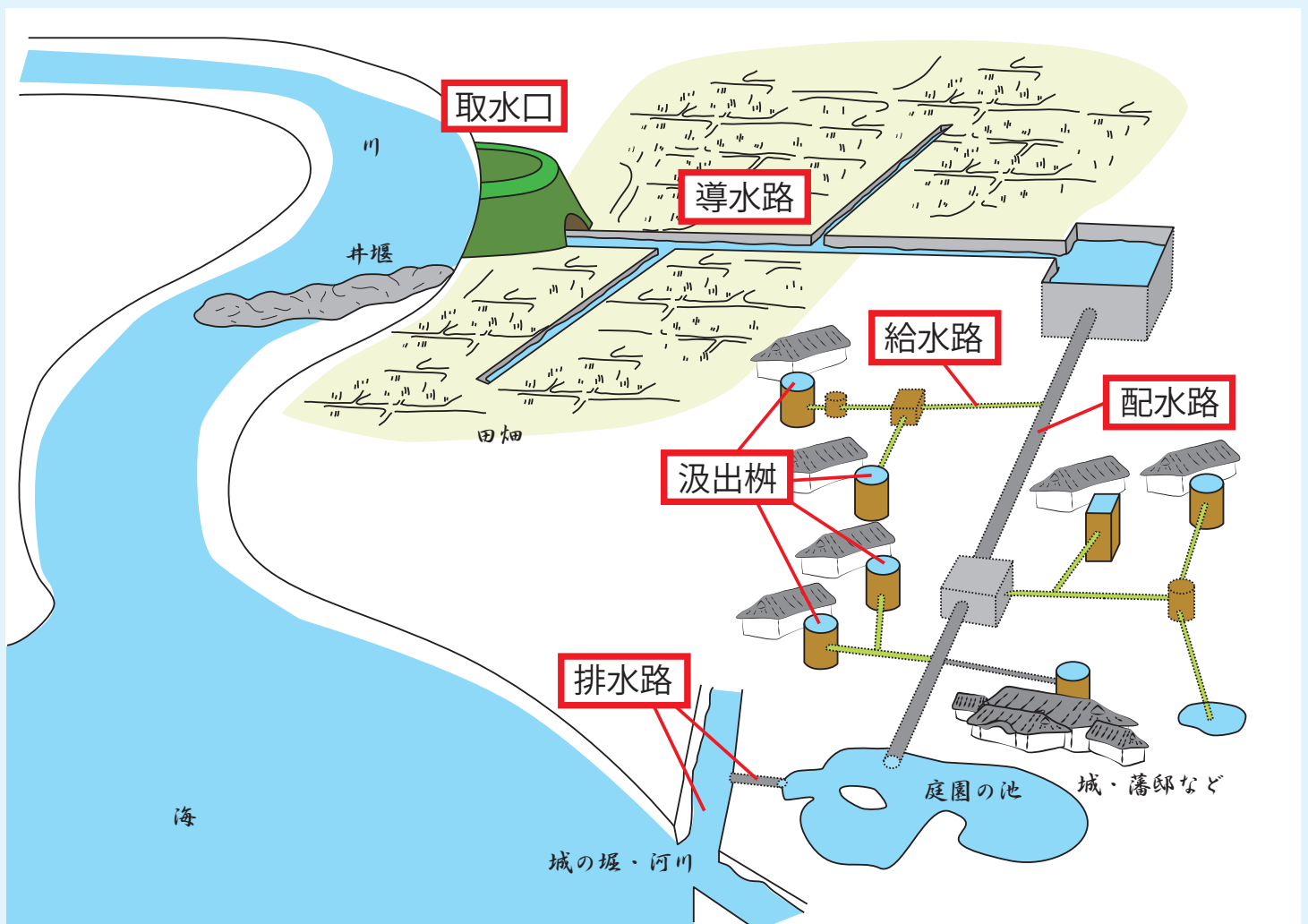
▲江戸時代の上水道のしくみ
